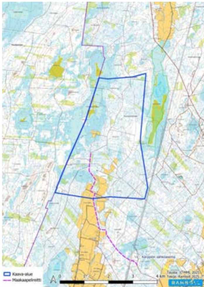
Kuva 2. Paulakankaan tuulivoimapuiston osayleiskaavan aluerajaus. Kuvassa on esitetty myös maakaapelireitti, jolla tuulivoimalat on suunniteltu liitettäväksi Kärpiön sähköasemalle (Peruskartta 2025 © Maanmittauslaitos).
